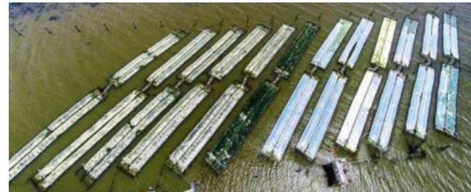
Les algues permettent le traitement d'eaux usées via des PBR flottants offshore
