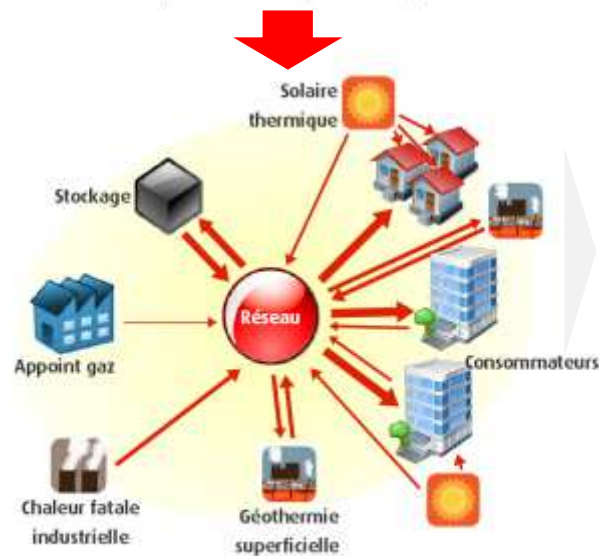
Principe du réseau "multipoints - multipoints"
