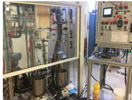
Pilote d'hydrogénation mono-canal (20 bar, 200°C)
